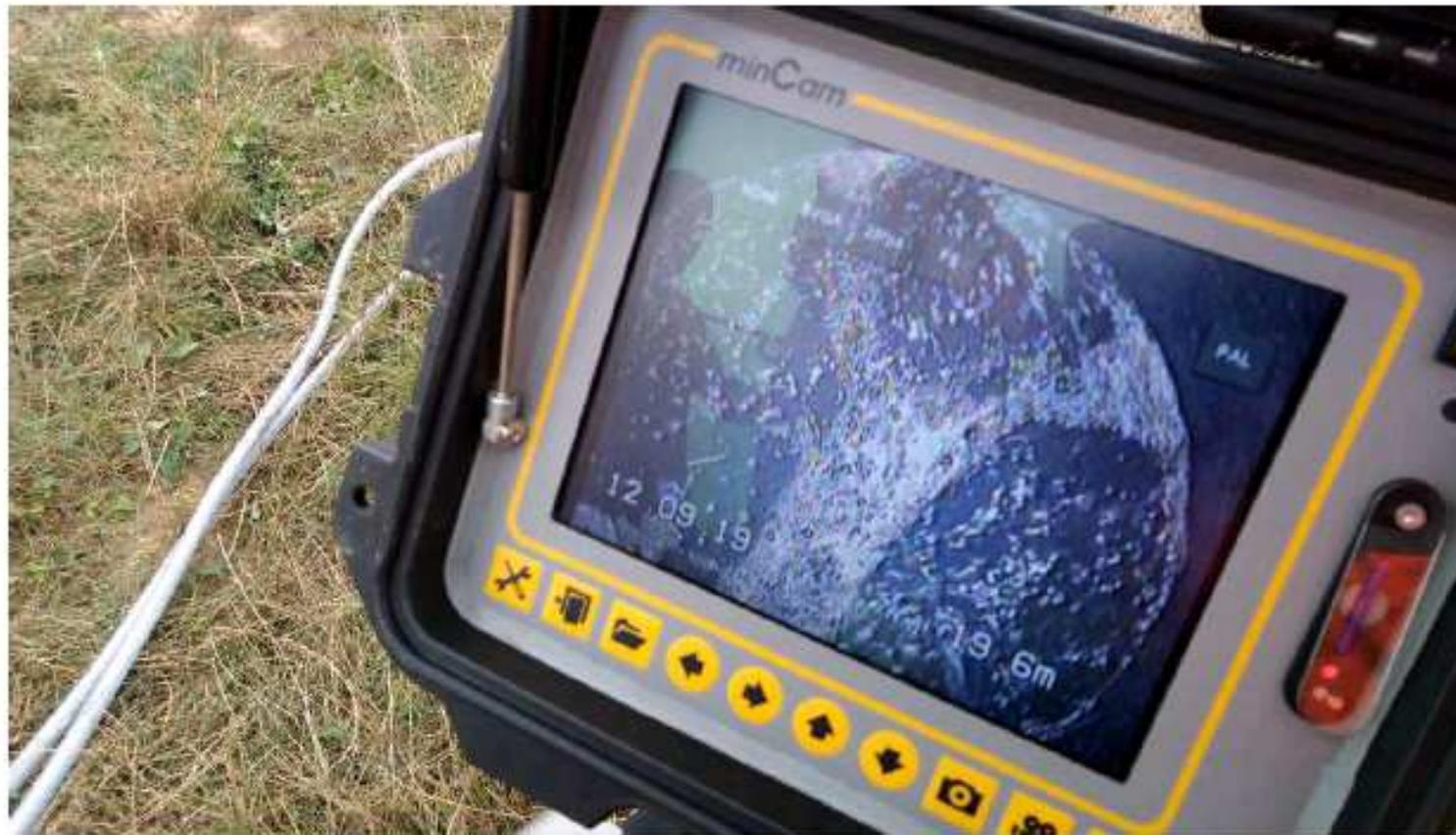
Le puits de l'alvéole 6 s'avère être passant (connecté aux drains de fond)
